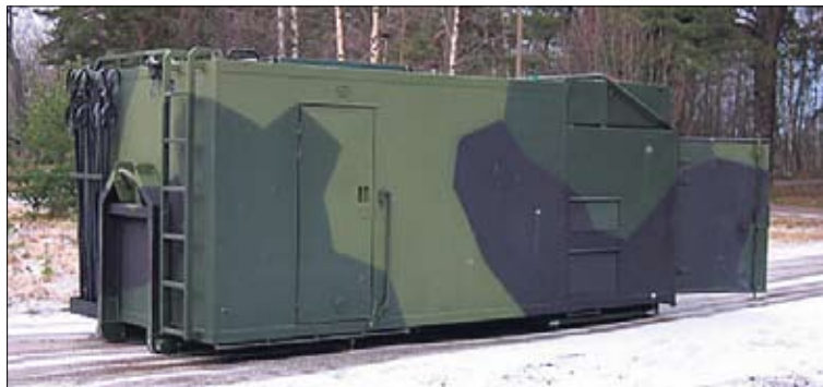
Laskentakeskus: Ammunnan suunnittelu ja johtaminen tuliyksikössä, useita radioita ja yhteysmahdollisuuksia, oma voimakone sähkön tuot- tamiseen.
