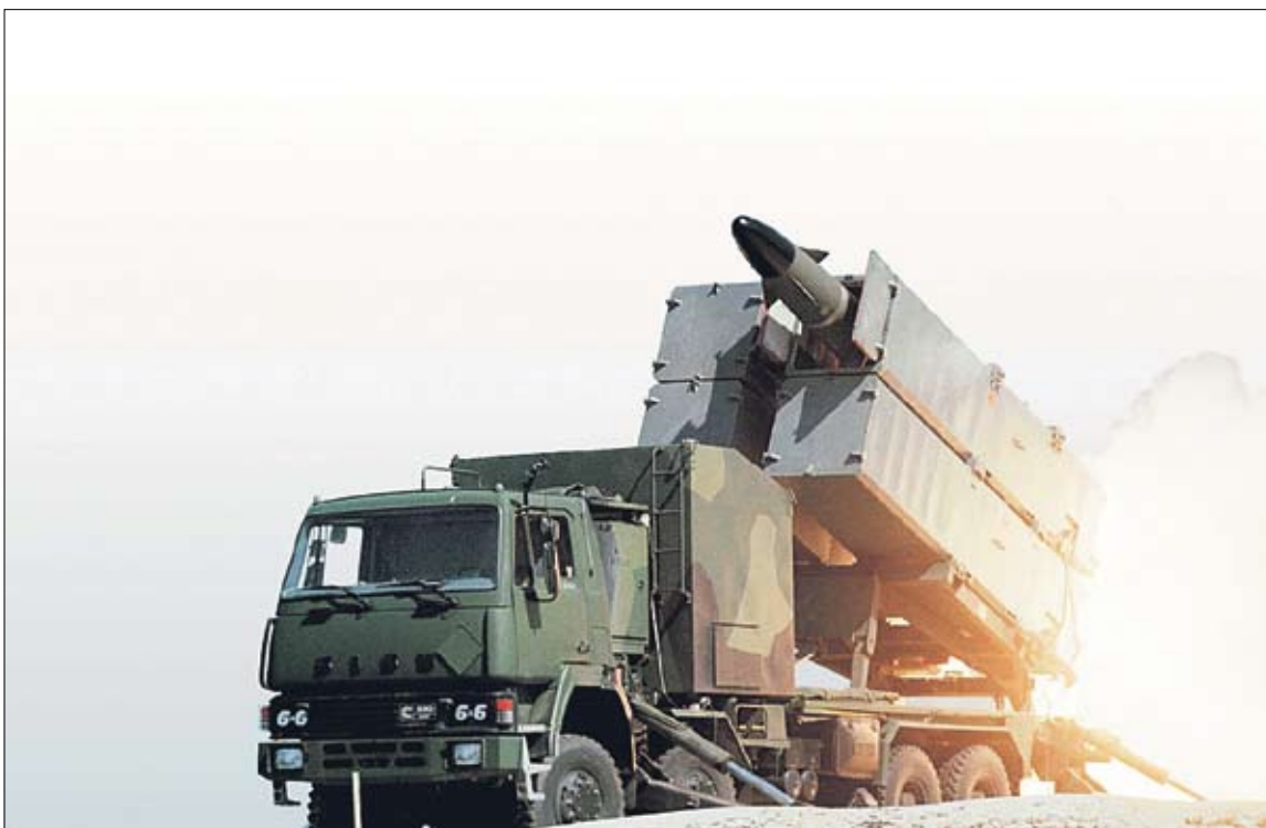
Lavettiajoneuvo: 4 meritorjuntaohjusta, oma voimakone sähkön tuottamiseen, kokonaismassa n. 26 tonnia, kyky itsenäiseen toimintaan suoraan tulenkäyttäjän tai maalinosoittajan johdossa.
